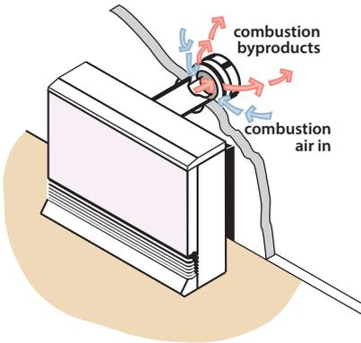
**Sealed-combustion space heater:**
